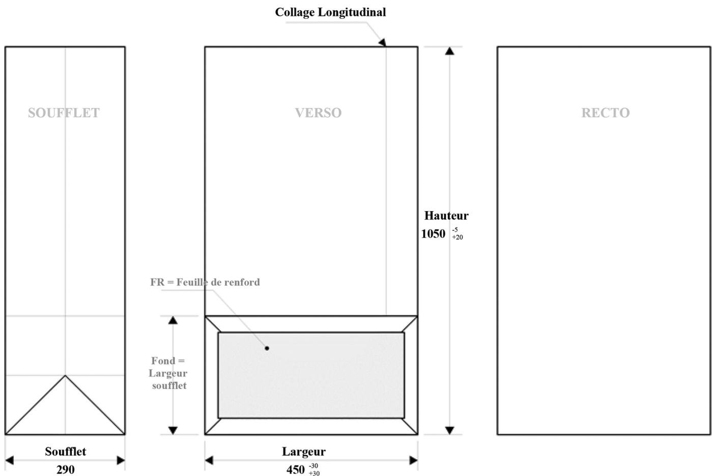
$1/2 \text{ PERIMETRE} = \text{dimension de la largeur} + \text{dimension du soufflet} \Rightarrow 740<sup>-30</sup>/<sub>+30</sub>$
